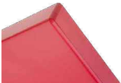
Figura 21. Bordo adeguatamente incollato
