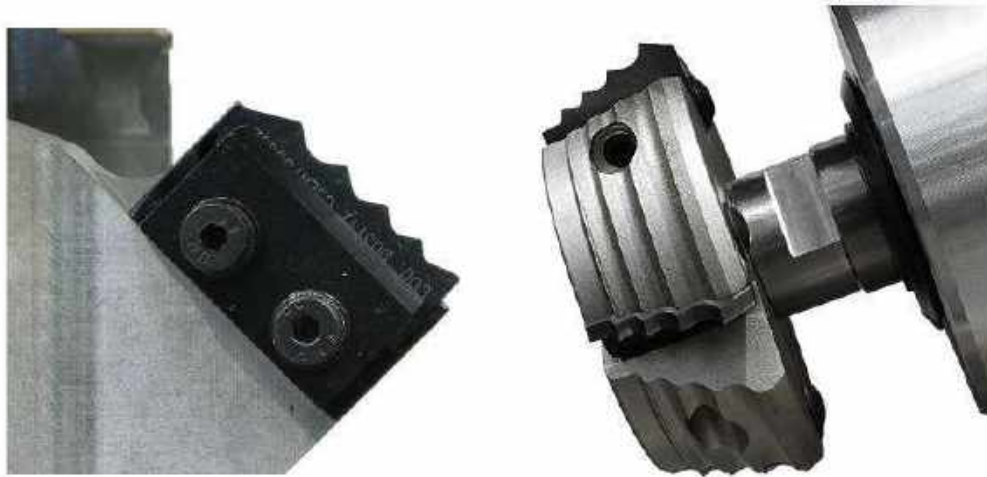
Figure 79. Esempio di utensili correttamente affilati
