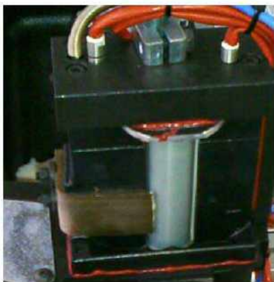
Figura 62. Rullo applicatore correttamente alimentato
