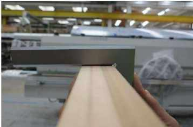
Figura 74. Esempio di pannello alto 45 mm rettificato con frese perfettamente in squadra
