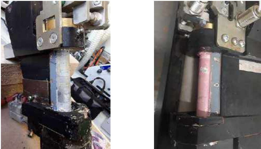
Figura 68. Esempi di testine con adesivo poliuretanico reticolato
