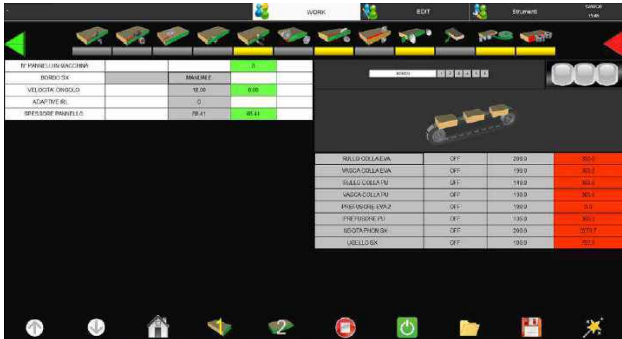
Figura 59. Pannello operativo di una bordatrice
