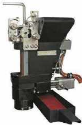
Figura 34. Rullo spalmatore alimentato dall'alto
